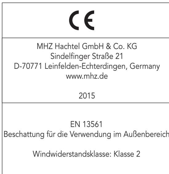
Die benannte Windwiderstandsklasse bezieht sich auf alle Standardgrößen bzw. Ausführungsvarianten der beim Kauf gültigen Preisliste. Für Sondergrößen, sowie Sonderanfertigungen kann keine Windwiderstandsklasse angegeben werden (Klasse 0, nicht geprüft).
