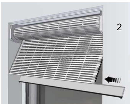
Endstab bei angehaltener Anlage seitlich einschieben. (Richtung siehe auch Bild 2).
