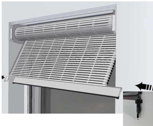
Endstabgleiter an beiden Enden der Schlussleiste einschieben. Nur am letzten Lamellenstab, vor der Schlussleiste dürfen keine Endkappen eingebracht werden
