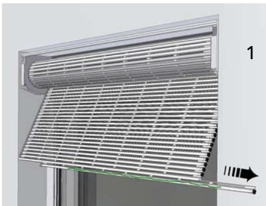
Wenn sich ca. 2/3 des Behanges im Kasten befinden, das markierte Transportprofil am unteren Ende des Behangs entfernen.
