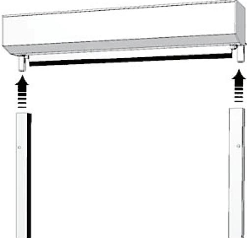
Führungsschienen bis zum Anschlag auf die Blendenkappenfüße aufschieben. Einlauftrichter nicht beschädigen!
