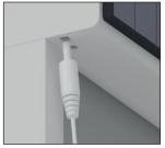
Notladebuchse (unter dem Solarpanel)
