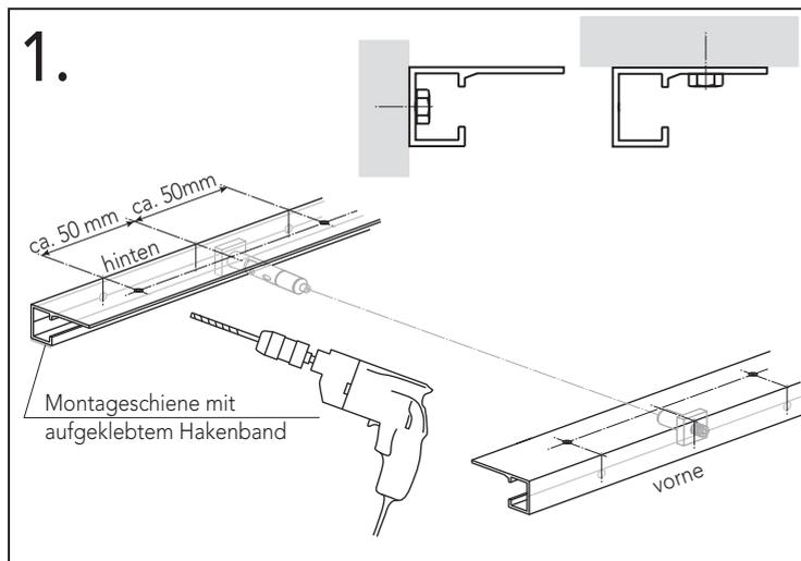
Wegen der hohen Zugkräfte muß das Montageprofil im Bereich in denen die Führungsseile positioniert werden, mit dem Untergrund verschraubt werden. Idealerweise so nahe wie möglich links und rechts am Führungsseil (ca. 50 mm) mit zwei Schrauben befestigen.
