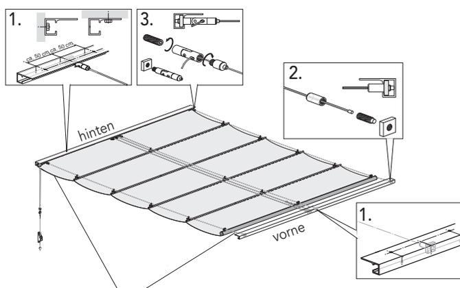
Führungsseile parallel zueinander ausrichten. Die Positionen können an den auf dem Behang vorpositionierten Klemmösen abgenommen werden.
