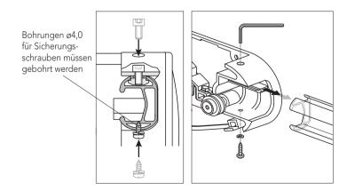
3. Seilführung in Führungsschiene beachten (Seilverlauf von oben nach unten)
