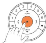
**Stop-Taste 6 Sek. betätigen.** → Tastenbeleuchtung am Sender blinkt.
