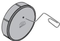
**P-Taste** am **neuen** Sender 6 Sek. → Kanaltasten am neuen Sender blinken nach 3 und 6 Sekunden. Sender ist im Programmiermodus.
