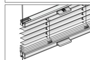
**Bedienung:** Einstellen der Behanghöhe durch Verschieben der Ober- bzw. Unterschiene. Schienen arretieren in jeder gewünschten Position. Wenden der Lamellen mittels Drehrad im Bediengriff an der Oberschiene. Bis 90 cm Breite mit 1 Bediengriff pro Schiene, ab 90,1 cm Breite mit 2 Bediengräften pro Schiene. Drehrad links und rechts bedienbar.
