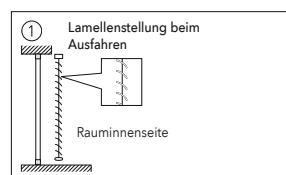
Modell 09-6191 mit 25 mm Lamellen für Slope-Fenster bis 45°
