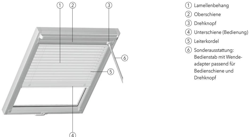
**Modell 09-3118** mit 25 mm Lamellen, Drehknopf für Lamellenwendung
